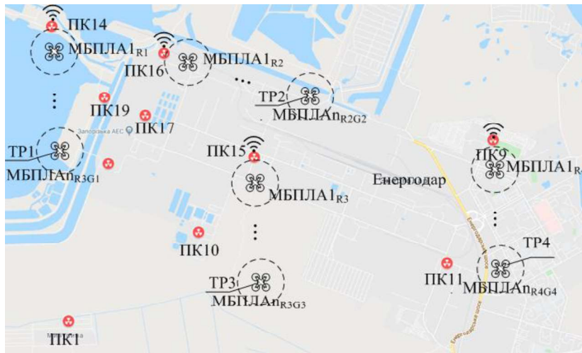
Рис. 2. Схема розгортання підсистем БПЛА-БМ на основі МБПЛА для організації передачі даних від постів контролю до точок “рандеву” під час післяаварійного моніторингу ЗАЕС
