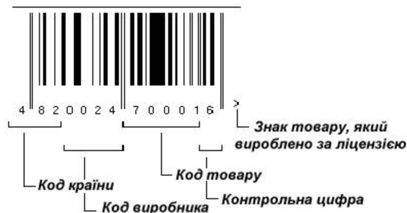
Рисунок 2.3 – Структура штрих-коду
