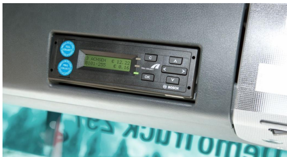
Рисунок 2.9 – Встановлена система Toll Collect в тахограф автомобіля [16]
