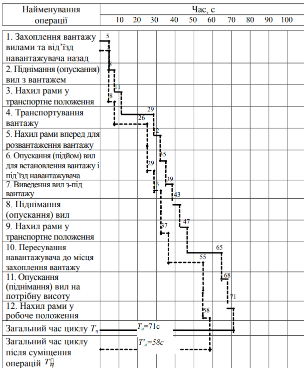
Рисунок 4.2 – Графіки середньої тривалості робочого циклу навантажувача при переробці тарно-штучних вантажів без суміщення операцій та з суміщенням [23]
