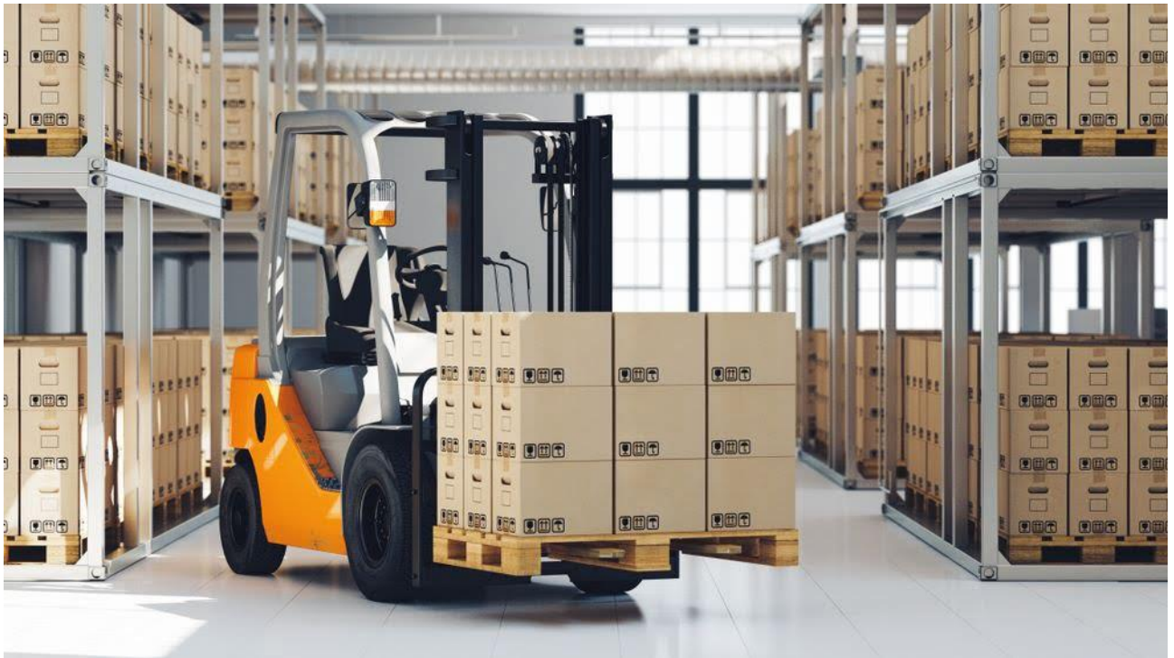
Рисунок 4.5 — Виконання операції переміщення вантажу всередині складу за допомогою електронавантажувача Heli CPD10
