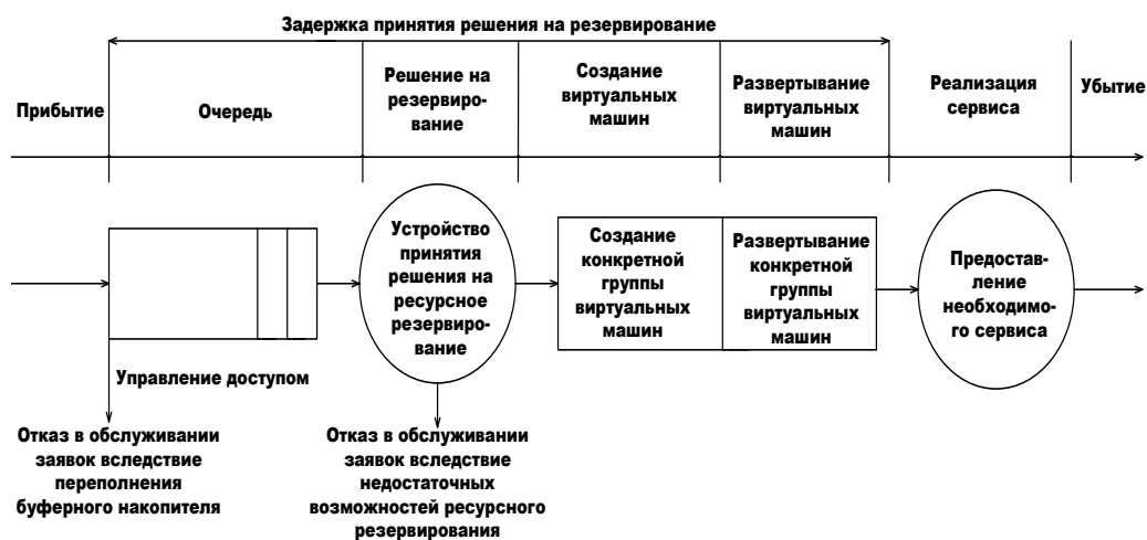
Рис. 2. Диаграмма пошагового моделирования процессов обслуживания заявок и ресурсного резервирования
