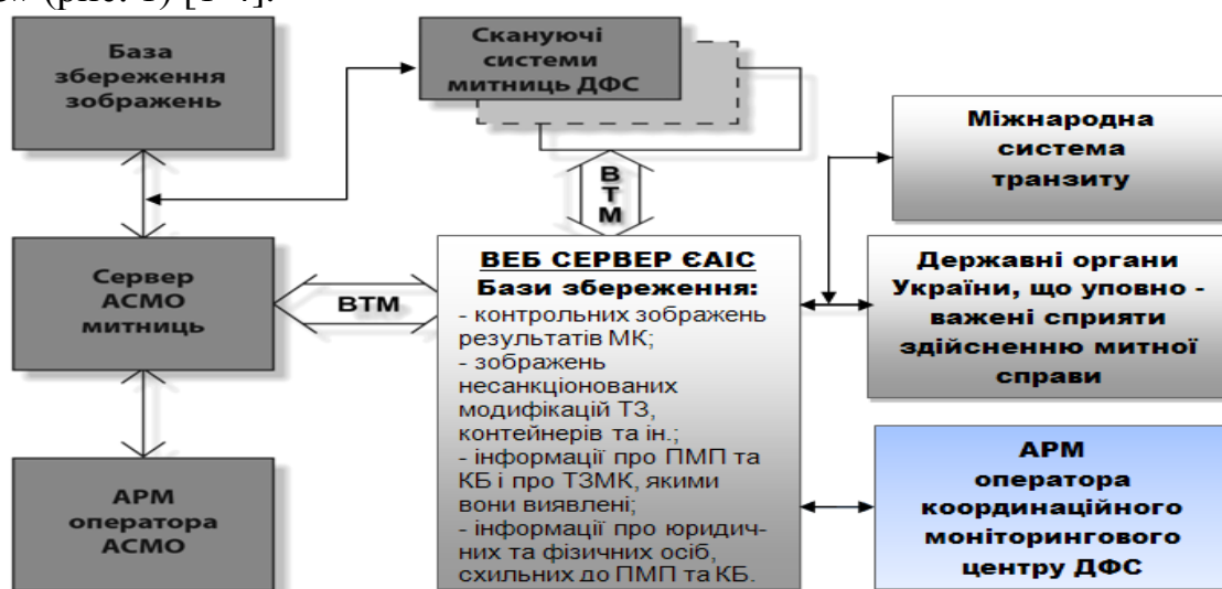
Рисунок 1. Блок – схема «Моделі програмно – апаратного комплексу забезпечення синхронізації та передачі результатів митного контролю, митного оформлення з митниць та скануючих систем до центрального серверу ЄАІС ДФС
