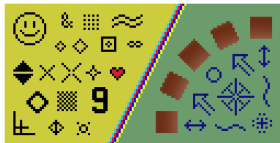
Рис. 3. Збільшення зображення утричі методом ближнього сусіда
