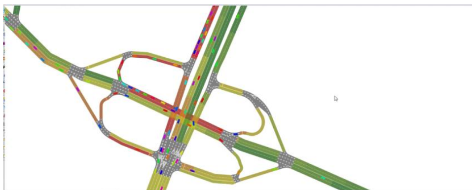
Рис. 1. Результат програмування зі збільшеним потоком і встановленим світлофором
