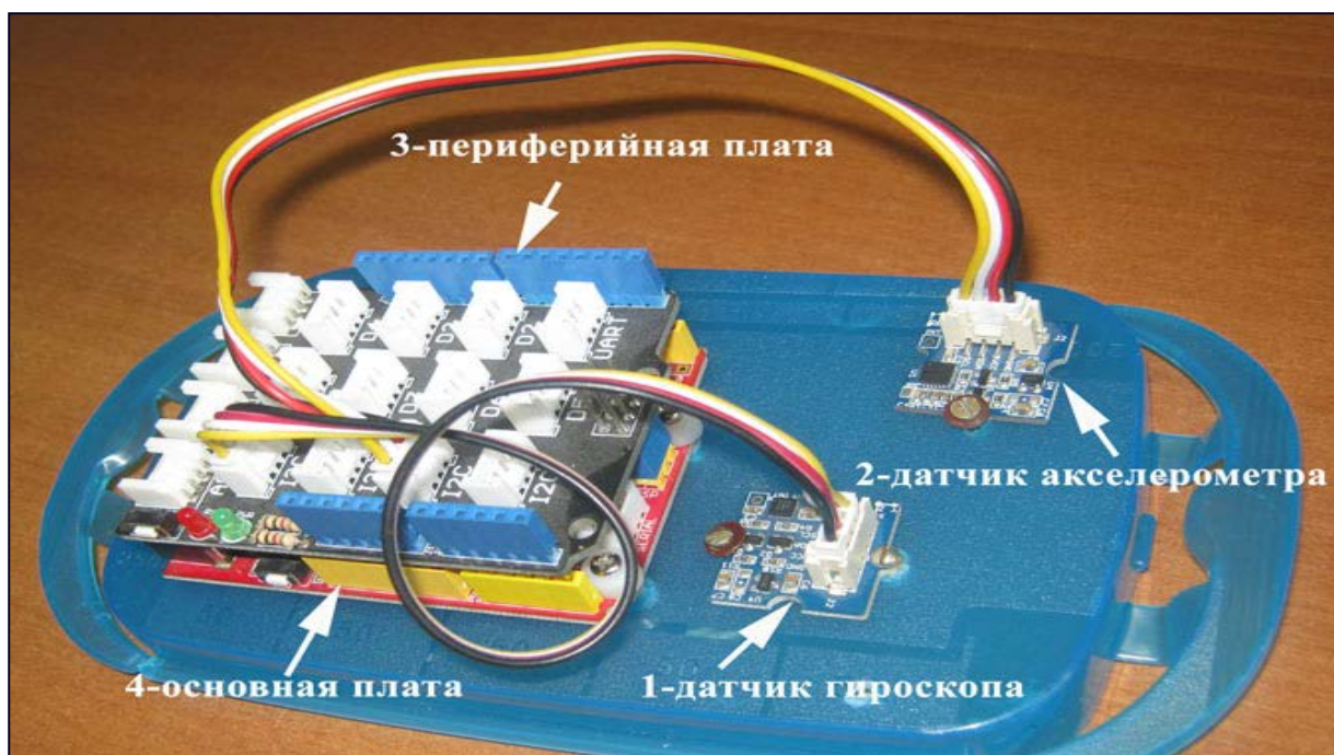
а) прибор фиксации всех видов судовой качки
