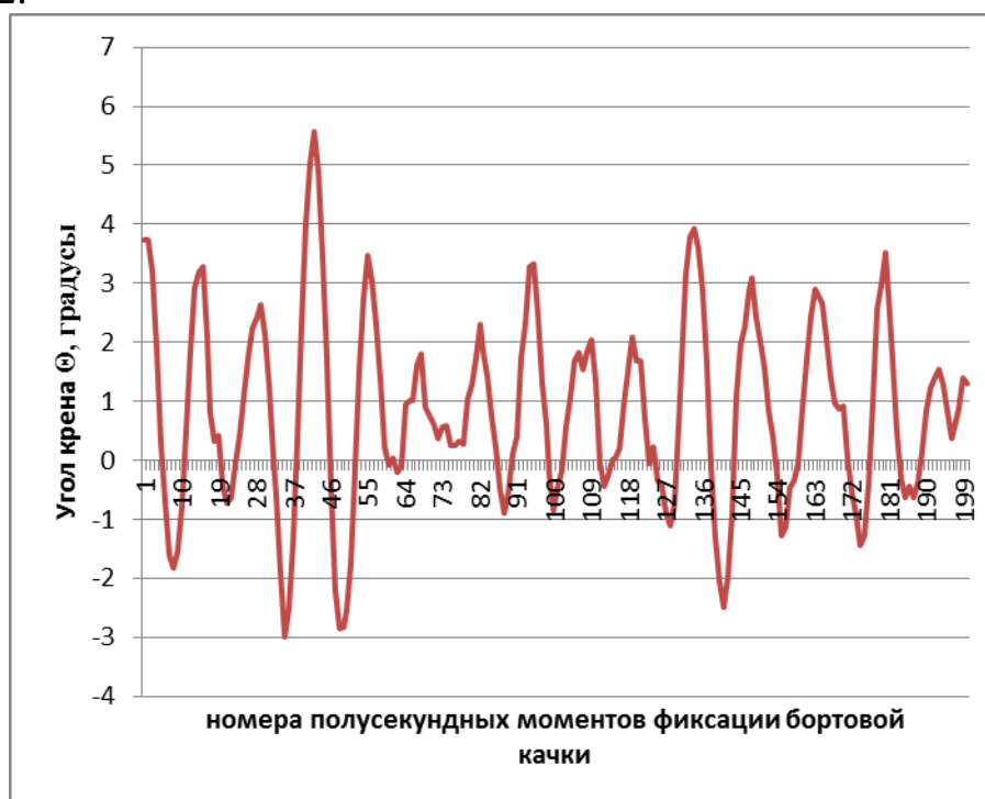
Рисунок 2. Пример записи бортовой качки, содержащей вторичные экстремумы без смены знака угла крена \Theta
