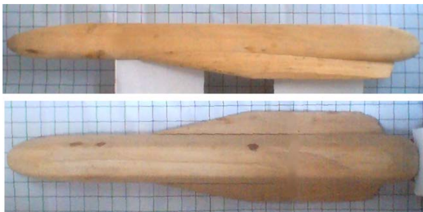
Рис. 1. Фото моделі високошвидкісного наземного транспортного апарату в крилевій компоновці з від'ємною V-подібністю крила [3].
