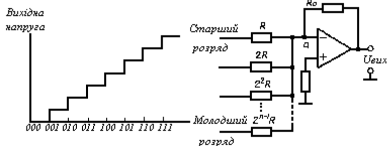
Рис. 7.1. Залежність вихідної напруги ЦАП від цифрового сигналу на вході
