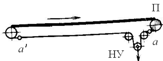
Рис. 2.20. Схема расположения привода и натяжного устройства на конвейере с увеличенной длиной трассы
