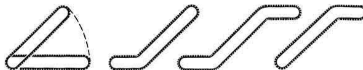
Рис. 3.32. Схемы трасс Z-образных конвейеров
