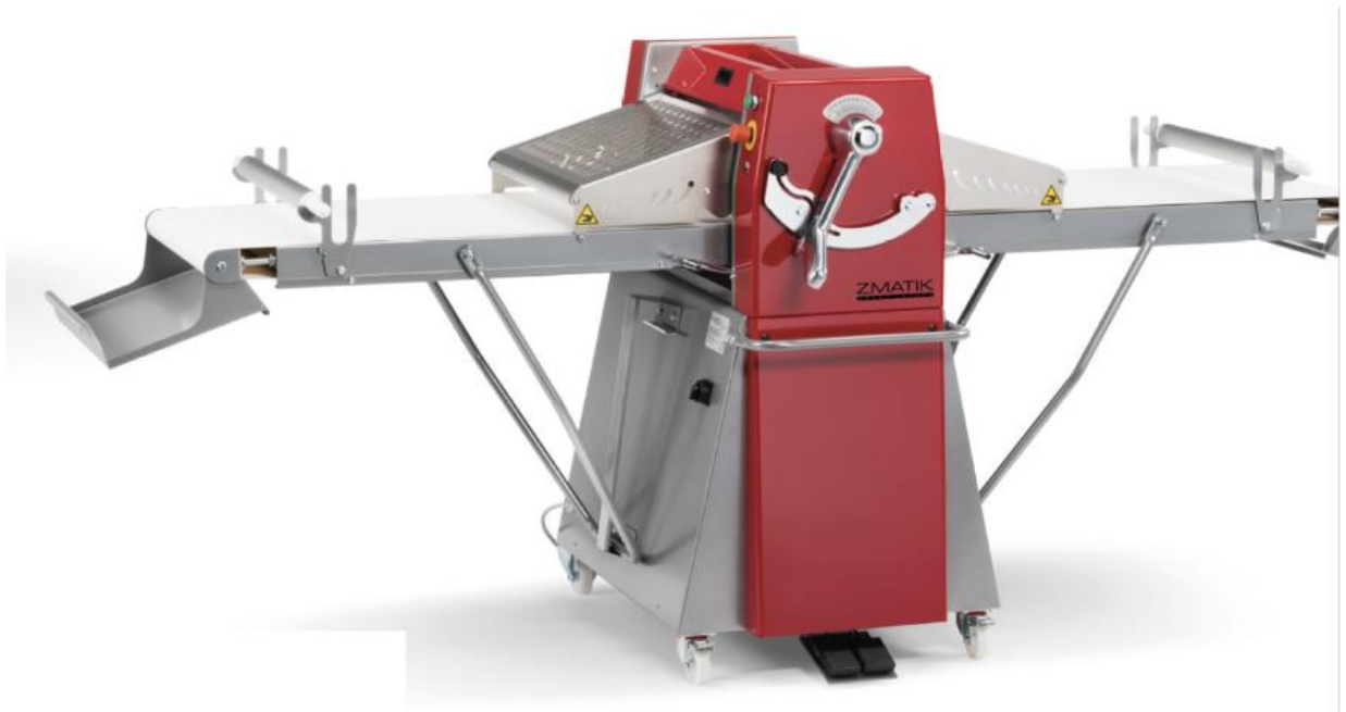
Рисунок 2.3 – Зовнішній вигляд тісторозкатка Zmatik SHE50075 [19]
