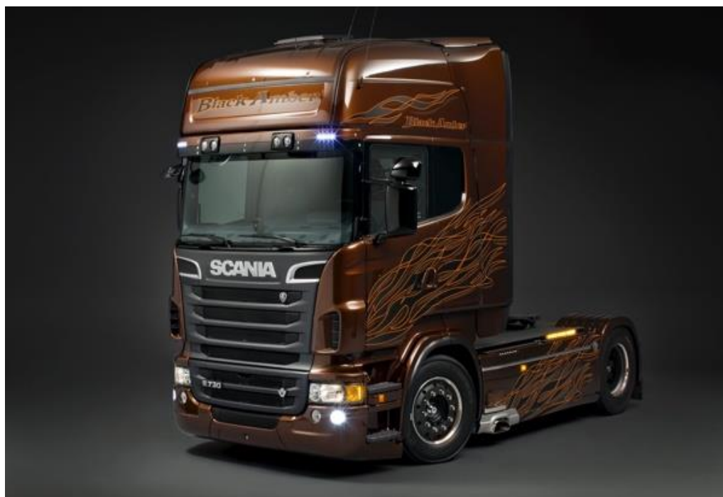
Рисунок 4.2 – Зовнішній вигляд Scania 730 hp 16.4-litre Euro 5 [22]
