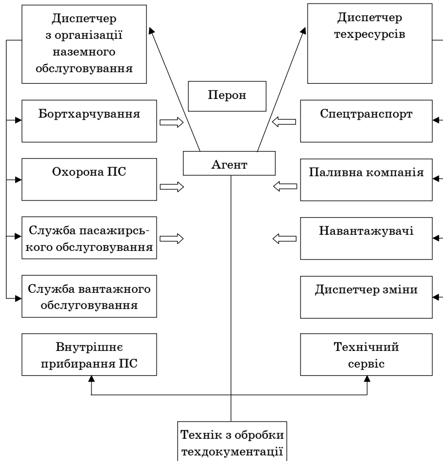
Рис. 5. Функціональна схема організації наземного обслуговування ПС в аеропорту "Бориспіль"
