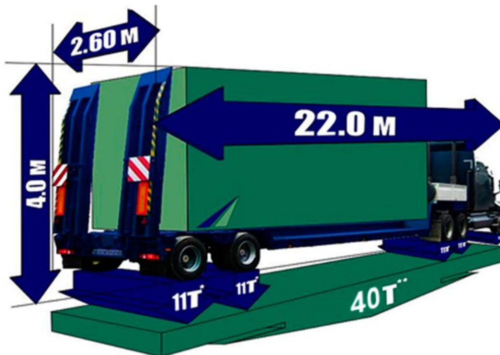
Рисунок 2.2 – Схематичне зображення перевищення стандартних габаритів вантажу [11]
