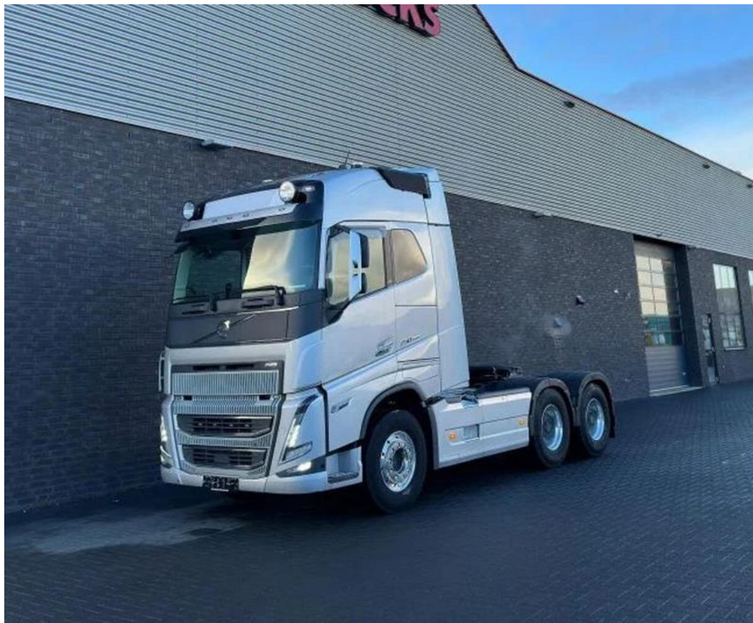
Рисунок 2.8 – Тягач Volvo FH16 750 6x4 в конфігурації для тралів (зовнішній вигляд) [17]
