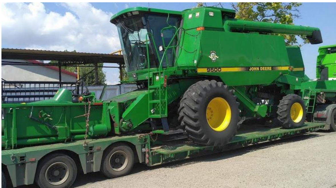
Рисунок 2.3 – Приклад кріплення негабаритного вантажу [9]
