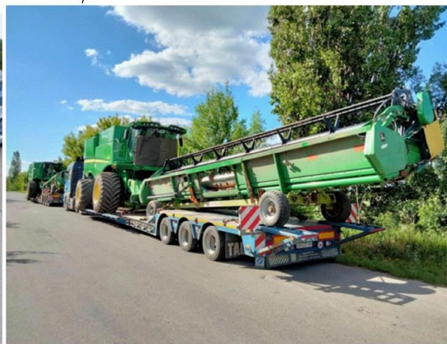
Приклад завантаження низькорамного траля комбайном із жаткою на балконі
