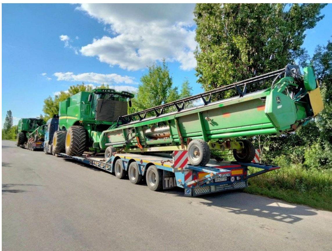
Рисунок 3.4 – Приклад завантаження низькорамного трала комбайном із жаткою на балконі
