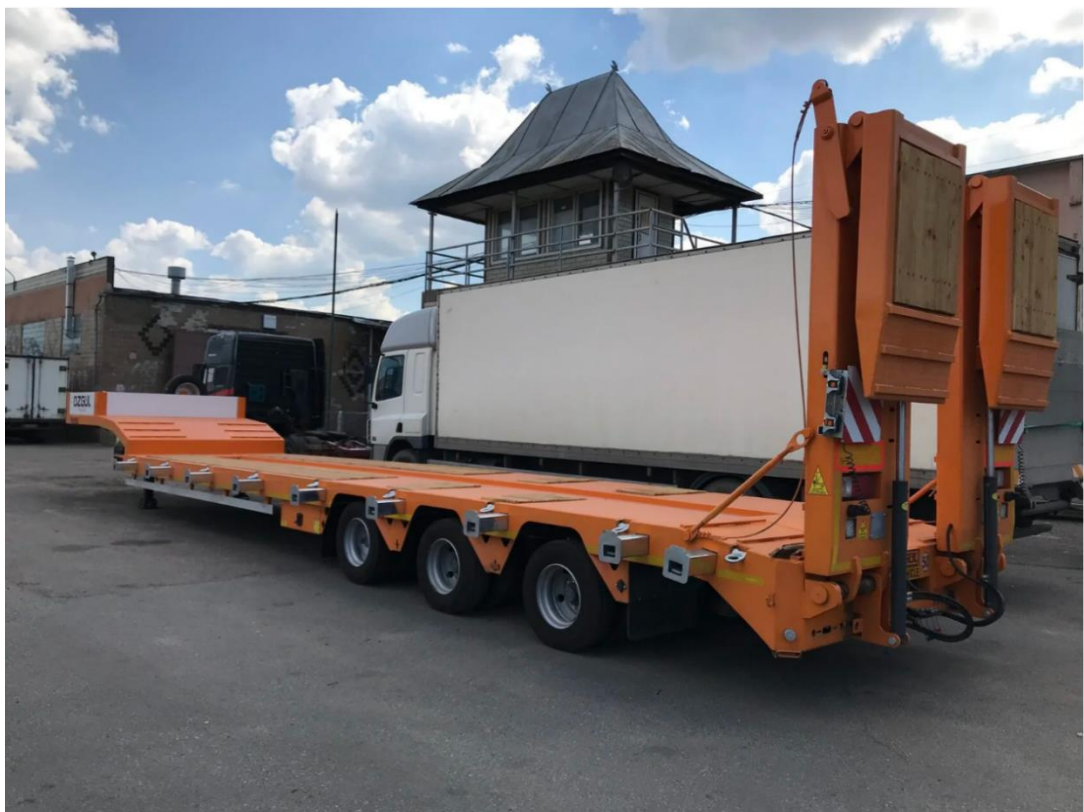
Рисунок 2.6 – Низькорамний 3-х осьовий напівпричіп трал Goldhofer (загальний вигляд) [16]
