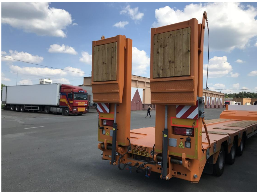
Рисунок 2.7 – Самозаїзди на низькорамному напівпричіпі [16]
