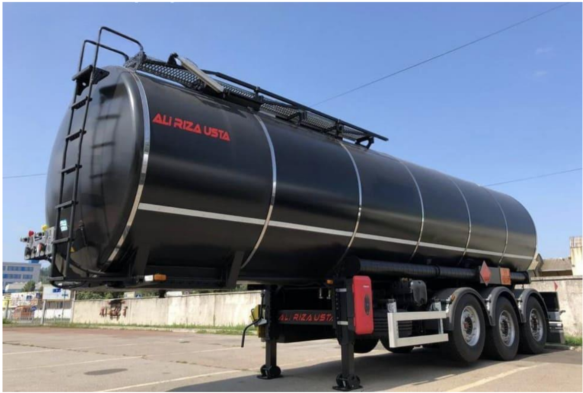
Рисунок 2.3 – Типова автоцистерна ADR-зчіпка для перевезення мастильних матеріалів [17]
