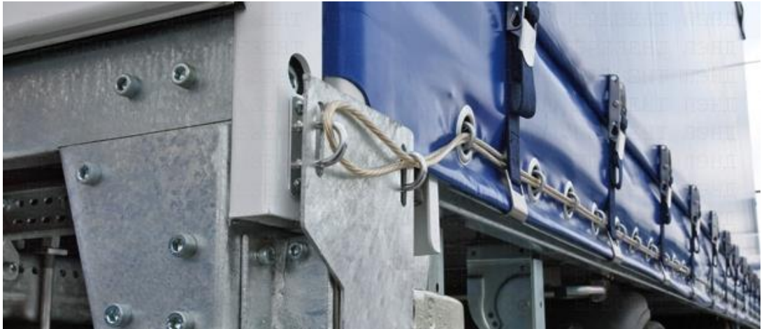
Рисунок 2.14 – Трос, який унеможливить доступ до вантажу [23]
