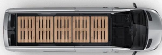
Схематичне зображення розміщення палет в кузові автомобіля Mercedes-Benz Sprinter
